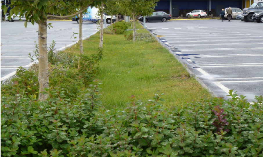
Mynd 4.8: Dæmi um regnvatns rás með trjágróðri á bílastæði IKEA í Garðabæ.
