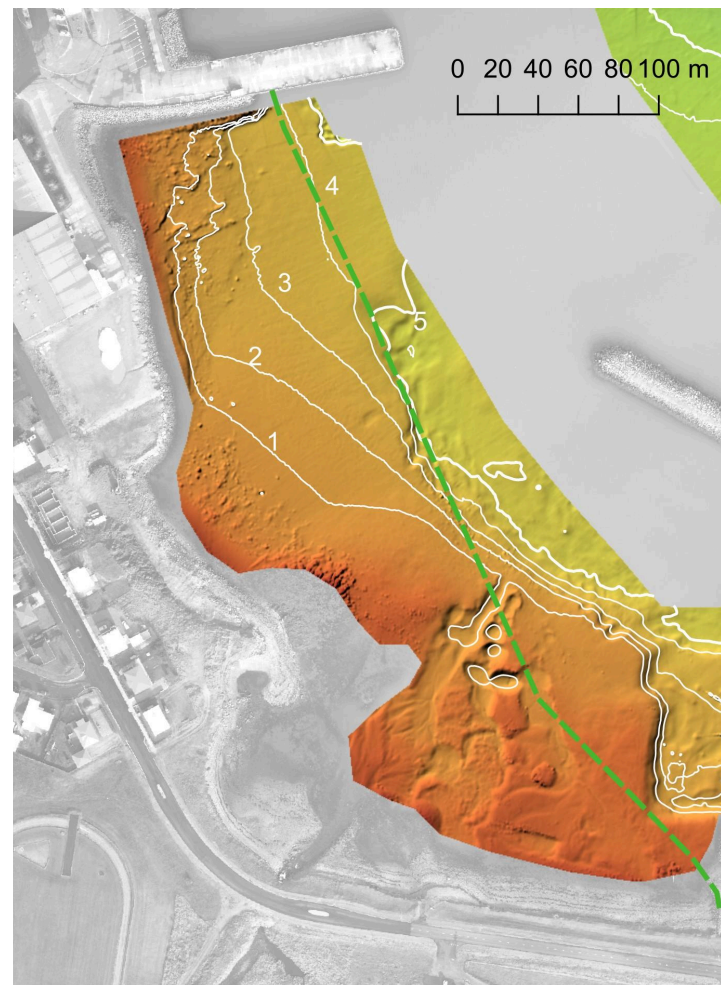
Mynd 2.4 sýnir dýpi við ströndina innan fyrirhugaðs stækkunarsvæðis Grundarfjarðarhafnar sem hér er lýst. Græn lína sýnir mörk stækkunarinnar. Dýpistölur miðast við sjómælingakerfi Grundarfjarðarhafnar, þar sem núllpunktur er við stórstraumsfjöruborð. Dýptarmæling var unnin vorið 2024 af Köfunarþjónustunni.
